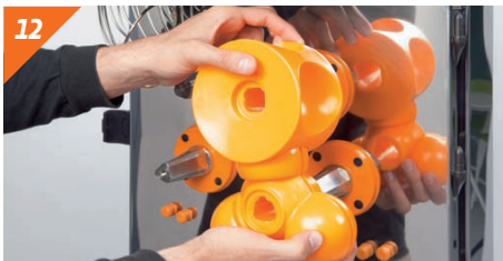
Stecken Sie die Presstrommeln paarweise auf.
